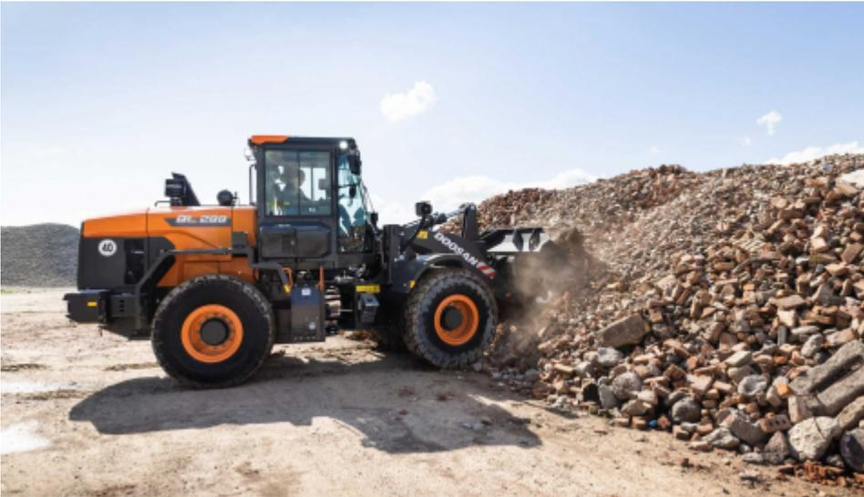
El modelo DL200-7, que es el más pequeño de la gama, monta un motor de 4 cilindros Perkins 1204J de Fase V que rinde 106 kW (144 CV) a 2200 rpm. Con una potencia de salida de 240 kW (326 CV) a 1800 rpm, el motor Scania DC09 de la DL420CVT-7 proporciona un generoso par a bajas revoluciones. Ambos motores cumplen las normas de emisiones de la Fase V gracias al uso de tecnologías postratamiento como la reducción catalítica selectiva, el
