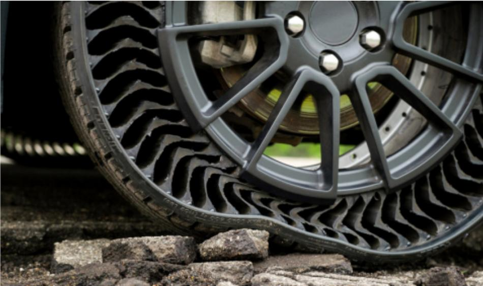
El fabricante francés de neumáticos Michelin presentó su primer prototipo de neumático diseñado a través de la fabricación aditiva: Uptis, que viene de *Unique Puncture-proof Tire System* o sistema anti pinchazos. Este nuevo desarrollo es un conjunto montado, es decir, rueda/neumático, ¿lo mejor? sin aire para evitar todos los pinchazos. La compañía trabajó con el fabricante estadounidense General Motors, que ya cuenta con
