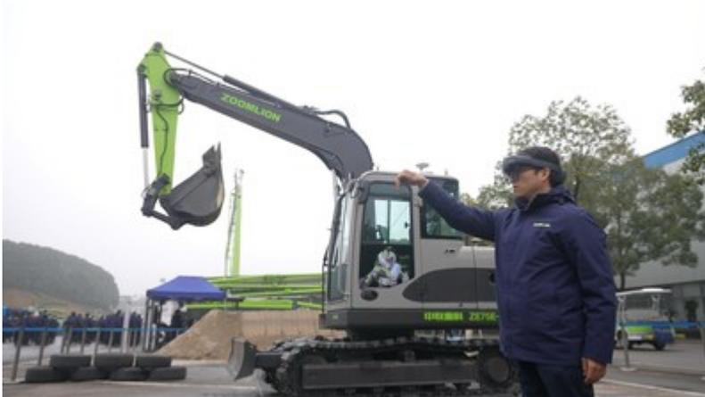
La excavadora equipada con un sistema de interacción hombre-máquina integra inteligencia artificial, control inteligente y otras tecnologías avanzadas, lo que permite a la excavadora interactuar con el operador y realizar tareas automáticamente, reconociendo tanto gestos como comandos de voz para trabajar con precisión.
